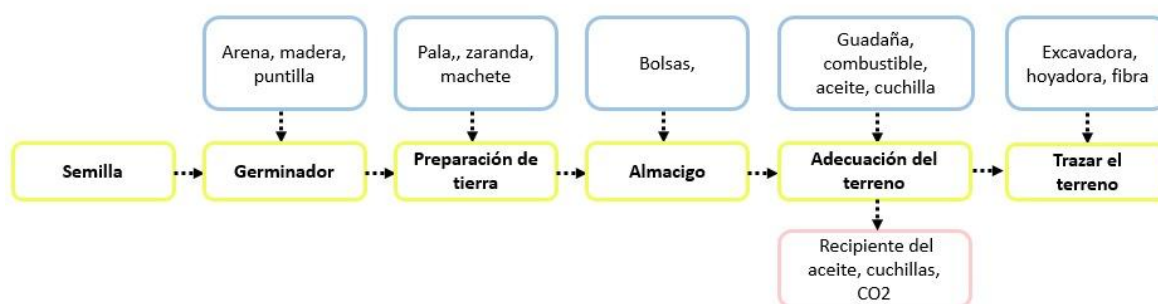
Figura 2 Diagrama de proceso producción de café
